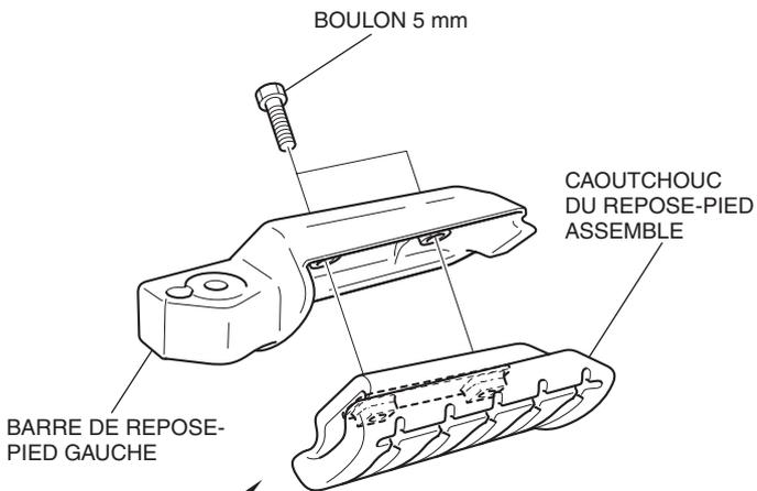
**Poussez le caoutchouc du repose-pied et serrez le boulon tout en levant la plaque du repose-pied comme indiqué.**
