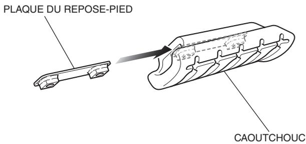
4. Installez le caoutchouc de repose-pied assemblé sur la barre de repose-pied gauche comme indiqué.
