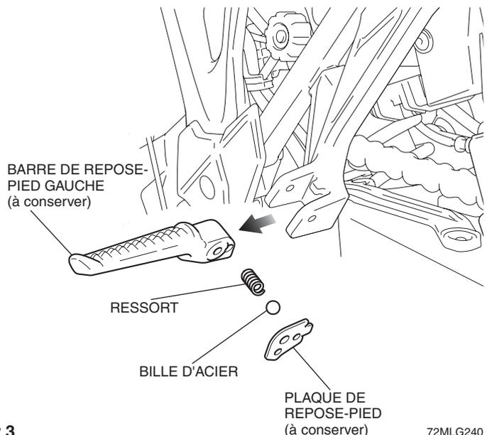
3. Assemblez la plaque du repose-pied et le caoutchouc du repose-pied comme indiqué.
