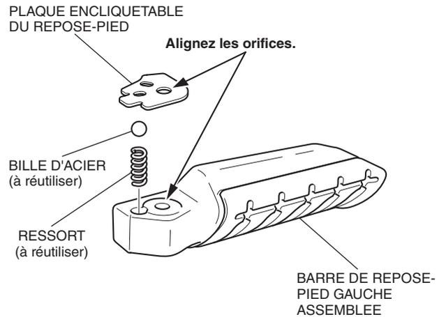
7. Installez l'ensemble de la barre de repose-pied gauche tout en maintenant abaissée la plaque encliquetable du repose-pied.
